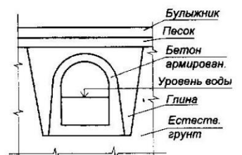
Разрез по трубе
