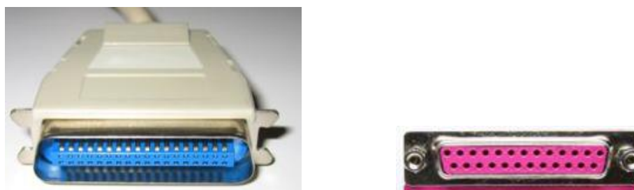
Рисунок 4.2 – Разъем интерфейса Centronics на кабеле и материнской плате
