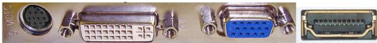
Рисунок 8.1 – Разъемы S-Video, DVI, VGA, HDMI
