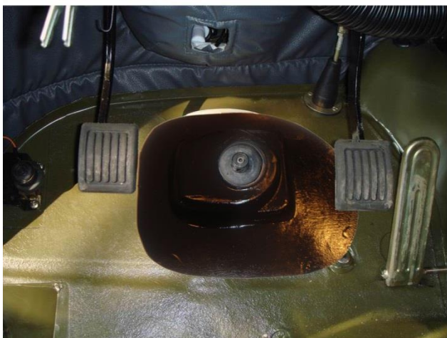
Крепление пыльника рулевого механизма
