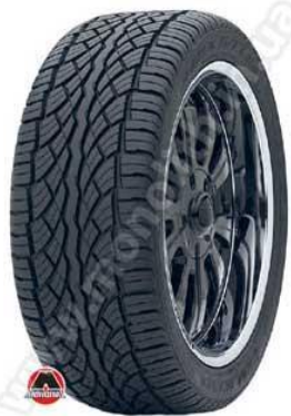
Рисунок 6.22 Пример шины с ненаправленным рисунком протектора.
