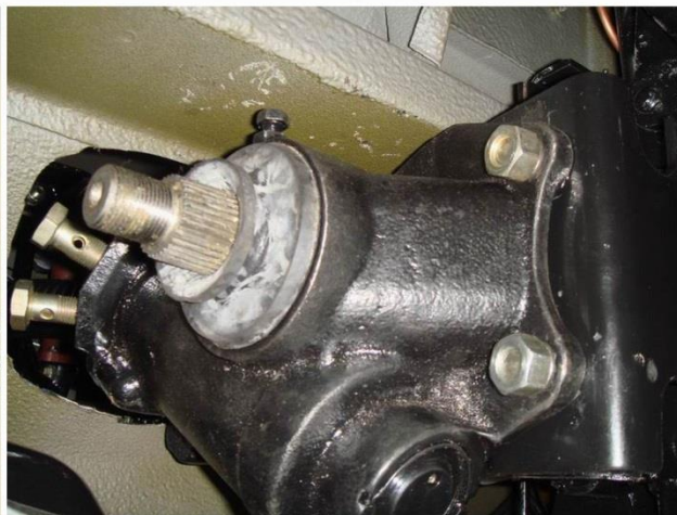
Крепление рулевого механизма к раме
