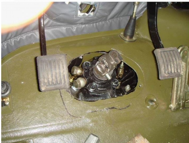
Рулевой механизм с карданчиком и шлангами
