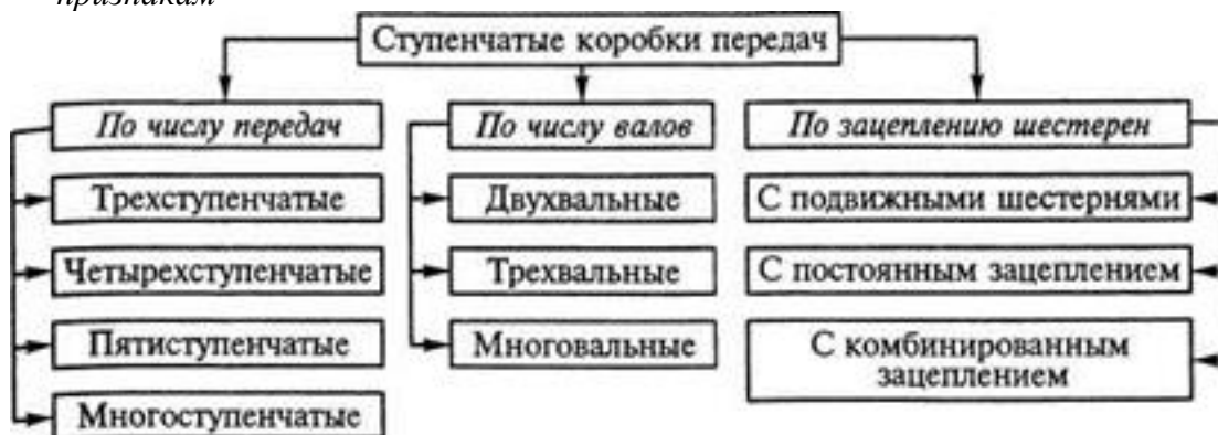
Типы ступенчатых коробок передач, классифицированных по различным признакам
