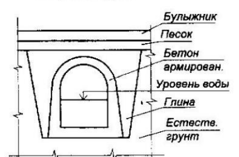
Разрез по трубе
