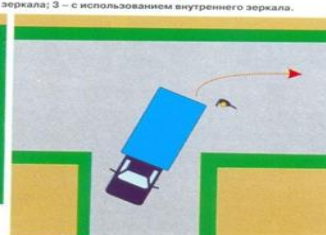
Выезд задним ходом из узкого проезда с участием помощника.
