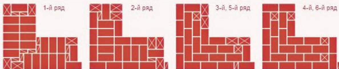
Сопряжение с внутренней стеной в 2 кирпича
