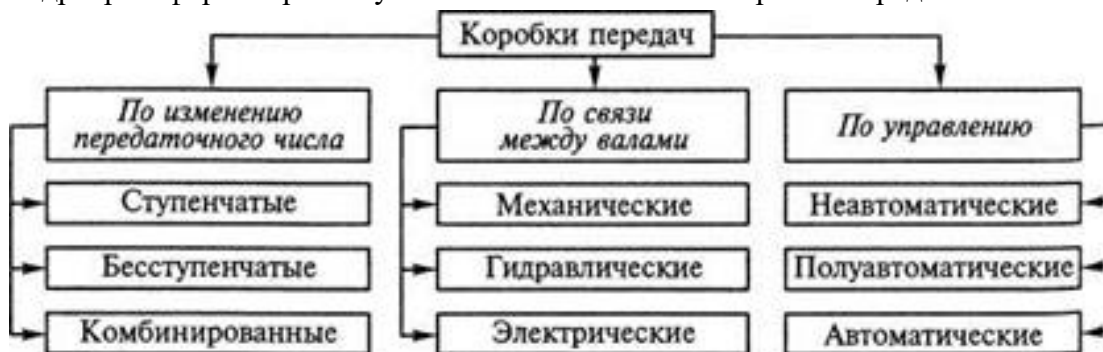
Типы коробок передач, классифицированных по различным признакам
