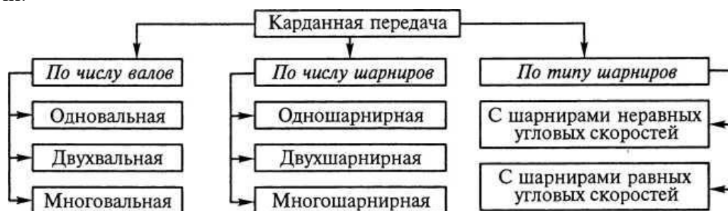
Типы карданных передач, классифицированных по различным признакам
