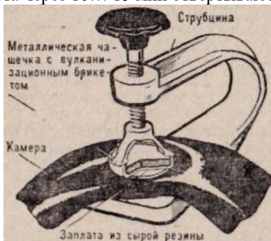
Рис. 1. Вулканизация камеры.
