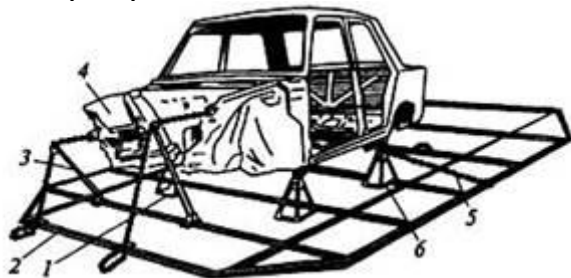
Рис.3. Стенд для правки кузова легкового автомобиля:
