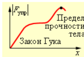
Зависимость силы упругости от удлинения
