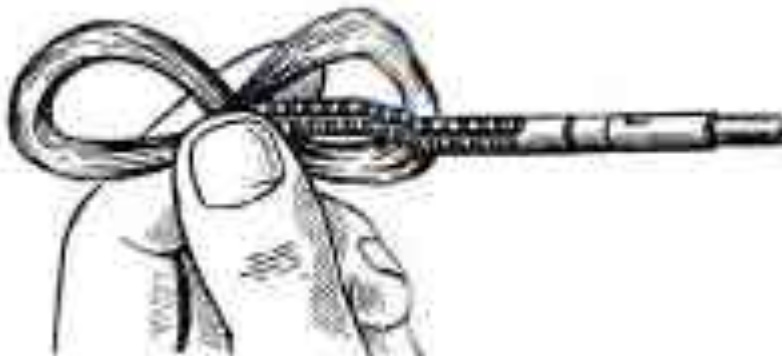
Рис. 57. Накладывая паклю на протирку
