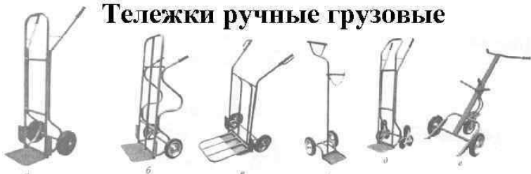
2-колесные (а-г) и специальные (д, е): а - КГ-250Д; б - КГ-300; в - КГ-200 (с откидной полкой); г - ККБ-1 (для транспортировки одного газового баллона); д - КС-150 (лестничная); е - КБ-350 (для бочек)
